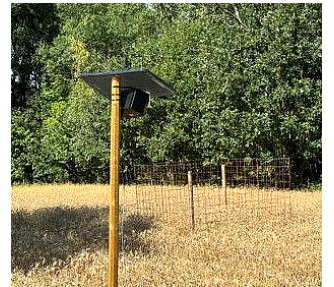
Apparaten Flox Fixed, numera Flox Edge, från Flox Robotics skrämmar bort vilt med ljud som djuren ogillar.
